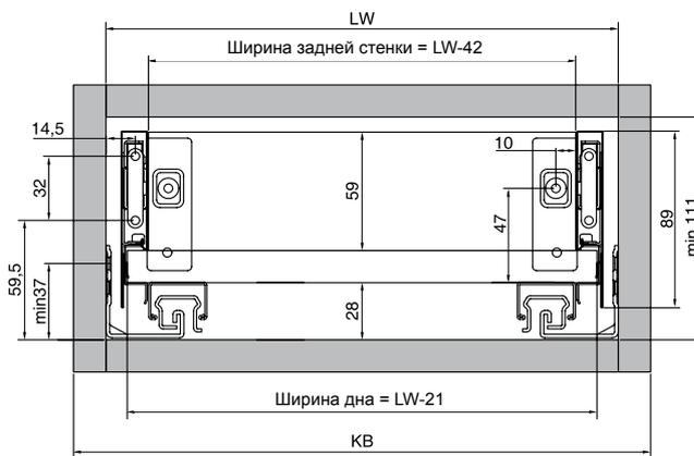
Размеры дна и задней стенки ящика для плиты 16 мм
